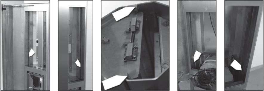
An jeder Seite (hinter dem FIBS), oben (unter dem Deckel) und an jeder Seite (hinter dem Laufkartenkasten) jeweils die Schrauben eindrehen.
