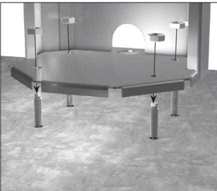
*Möglichkeit 1: Variante mit chemischen Ankern. Die Säule wird mit Sicherheitsmutter auf die aus dem Boden ragenden Gewinde aufgeflanscht.*
