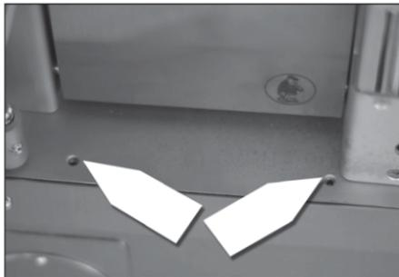
FSD öffnen und unten 2 Schrauben lösen.
